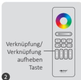
Drücken Sie die Taste „I“ innerhalb von 3 Sekunden 5-mal kurz.
