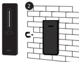
Kleben Sie die Halterung an die Wand und legen Sie die Fernbedienung in die Halterung
