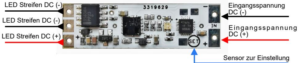
Abb. 1 - Verdrahtungsdiagramm des Dimmer-Moduls
