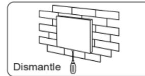
Zur Demontage mit einem kleinen Schlitz- Schraubendreher von unten den Schalter raushebeln.
