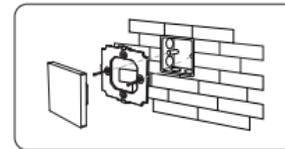
Schrauben Sie die Grundplatte mit den Schrauben fest.
