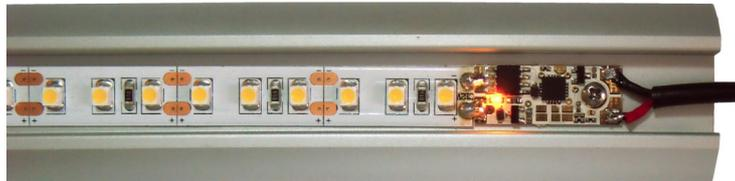
Abb. 1 - Veranschaulichung der Installation in das Profil
