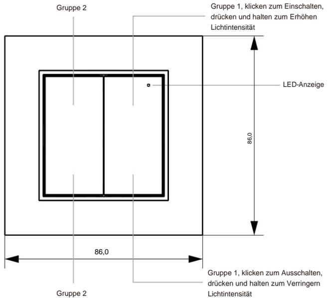
**Hinweis:** Diese Fernbedienung unterstützt 2 Gruppen zum Binden von maximal 30 Beleuchtungsgeräten.
