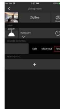
Von Ihrem ZigBee-Controller oder Hub Schnittstelle, wählen Sie Löschen oder Zurücksetzen Fernbedienung wie angegeben, Anzeige blinkt 3 Mal schnell, um anzuzeigen erfolgreiches Entfernen.
