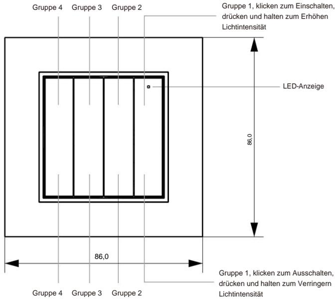
**Hinweis:** Diese Fernbedienung unterstützt 4 Gruppen zum Binden von maximal 30 Beleuchtungsgeräten.
