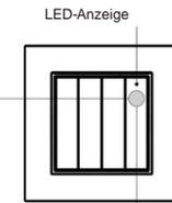
Schritt 3: Drücken Sie die EIN-Taste der Gruppe 1 fünfmal hintereinander kurz, um alle gebundenen Beleuchtungsgeräte zu löschen. LED-Anzeige blinkt 4 Mal für erfolgreiche Entbindung.
