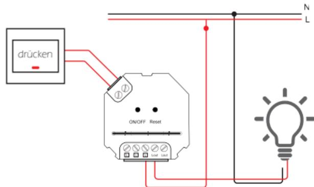
Das Gerät ist mit Taster und normalen Schaltern kompatibel. Die Zeit, in der Sie den Taster drücken, sollte nicht mehr als 400 ms betragen. Wenn mehr als 400 ms vergehen, erkennt das Gerät den Taster als normalen Schalter und als zwei normale Schalter. Die Zeit, in der Sie den Schalter drücken und loslassen, sollte nicht weniger als 400 ms betragen, sonst erkennt das Gerät den Taster als normalen Schalter.
